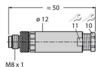
Konfektionierbarer Stecker, M8 x 1, gerade, 3-polig, Schraubklemmanschluss, Leitungsdurchlass 3.5 bis 5.0 mm, Adernquerschnitt/ Klemmvermögen 0.14 bis 0.50 mm <sup>2</sup> , Kunststoffgehäuse, Metallüberwurfschraube |         |
