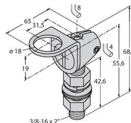
Montagewinkel, Werkstoff VA 1.4401, für 18mm-Gewinde, Gewinde M10 x 1,5
