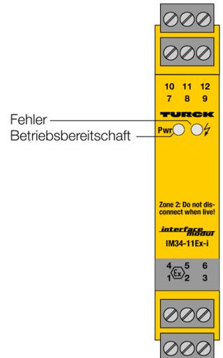
Mit dem 1-kanaligen Ex-Temperatur-Messverstärker des Typs IM34-11EX-I werden die temperaturabhängigen Änderungen von Ni100/Pt100-Widerständen, Thermoelementen der Typen B, E, J, K, L, N, R, S und T oder Kleinspannungen im Bereich von -100...+160 mV ausgewertet und als Stromsignale von 0/4...20 mA temperaturlinear ausgegeben.
