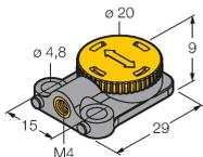
Freier Positionsgeber für Linearwegsensoren LI-QR14 und LI-Q17L; Quer- und Längsbefestigung möglich; der Nennabstand zum Sensor beträgt 1,5 mm; Kopplung mit dem Linearwegsensor bei einem Abstand von bis zu 3 mm oder einem Querversatz bis zu 3 mm
