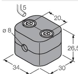
Befestigungsschelle für Glatt- und Gewinderohrsensoren; Werkstoff: Polypropylen
