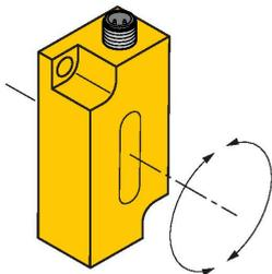
Einstellung des Messbereiches mittels Teachadapter TX1-Q20L60
