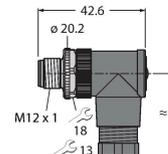
Konfektionierbarer Stecker, M12 x 1, gewinkelt, 4-polig, Schraubklemmanschluss, Leitungsdurchlass 4.0 bis 6.0 mm, Adernquerschnitt/ Klemmvermögen 0.14 bis 0.75 mm<sup>2</sup>, Kunststoffgehäuse, Metallüberwurfschraube
