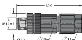
Konfektionierbarer Stecker, M12 x 1, gerade, 4-polig, Push-In-Anschluss, Leitungsdurchlass 4.0 bis 8.0 mm, Adernquerschnitt/ Klemmvermögen 0.14 bis 0.75 mm<sup>2</sup>, Kunststoffgehäuse, Metallüberwurfschraube
