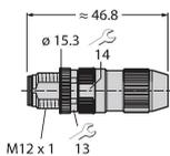
Konfektionierbarer Stecker, M12 x 1, gerade, 4-polig, Schneidklemmanschluss, Leitungsdurchlass 4.0 bis 5.1 mm, Adernquerschnitt/ Klemmvermögen 0.14 bis 0.34 mm<sup>2</sup>, Kunststoffgehäuse, Metallüberwurfmutter
