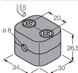
Befestigungsschelle für Glatt- und Gewinderohrsensoren; Werkstoff: Polypropylen
