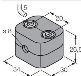
Befestigungsschelle für Glatt- und Gewinderohrsensoren; Werkstoff: Polypropylen
