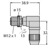
Konfektionierbarer Stecker, M12 x 1, gewinkelt, 4-polig, Schneidklemmanschluss, Leitungsdurchlass 4.0 bis 5.1 mm, Adernquerschnitt/ Klemmvermögen 0.14 bis 0.34 mm<sup>2</sup>, Kunststoffgehäuse, Metallüberwurfmutter
