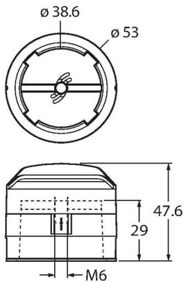
Betätigungselement (Puck) für Doppelsensoren; Endlage bedämpft; Lochbild auf Flanschfläche: 80 x 30 mm und 130 x 30 mm; Anschlusswelle (Wellenzapfen) Höhe: 30 mm / Ø: max. 35 mm; Optional erhältlich: Distanzstück BTS-DSC26-UR10 für 20 mm hohe Anschlusswellen (Wellenzapfen)
