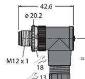
Konfektionierbarer Stecker, M12 x 1, gewinkelt, 4-polig, Schraubklemmanschluss, Leitungsdurchlass 4.0 bis 6.0 mm, Adernquerschnitt/ Klemmvermögen 0.14 bis 0.75 mm<sup>2</sup>, Kunststoffgehäuse, Metallüberwurfschraube
