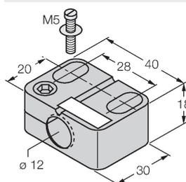
Befestigungsschelle für Gewinderohrsensoren, mit Festanschlag; Werkstoff: PA6
