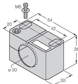
Befestigungsschelle für Gewinderohrsensoren, mit Festanschlag; Werkstoff: PA6
