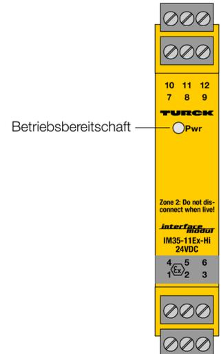
Über den 1-kanaligen Signaltrenner IM35-11EX-HI/24VDC wird das normierte Stromsignal galvanisch getrennt aus dem Nicht-Ex-Bereich in den Ex-Bereich ohne Beeinflussung 1:1 übertragen. Neben dem Analogsignal können bidirektional auch die digitalen Signale der HART®-Kommunikation übertragen werden.
