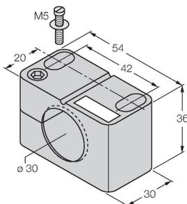
Befestigungsschelle für Gewinderohrsensoren, mit Festanschlag; Werkstoff: PA6
