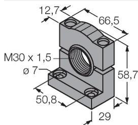
Montagehalterung, PBT-schwarz, für Sensoren mit 30-mm-Gewinde, ausrichtbar
