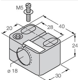
Befestigungsschelle für Gewinderohrsensoren, mit Festanschlag; Werkstoff: PA6
