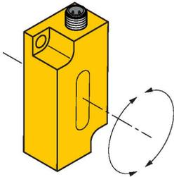
Einstellung des Messbereiches mittels Teachadapter TX1-Q20L60
