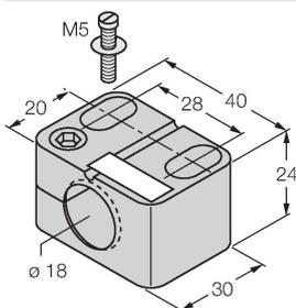
Befestigungsschelle für Gewinderohrsensoren, mit Festanschlag; Werkstoff: PA6
