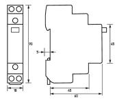
Maßzeichnung Stromstoßschalter (Fernschalter) RS 012-100
