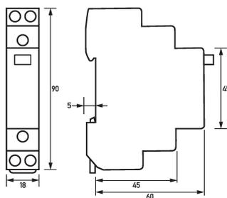
Maßzeichnung Stromstoßschalter (Fernschalter) RS 024-200
