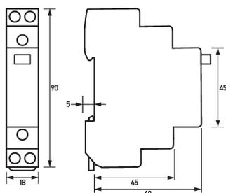
Maßzeichnung Stromstoßschalter (Fernschalter) RS 230-100
