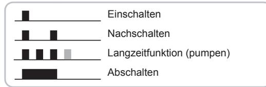
Der zusätzliche Steuereingang C1-C2 ermöglicht im Modus T und TW die Ansteuerung des Treppenlichtautomaten durch eine Spannung von 8 bis 230V AC/DC. Über diesen Eingang lässt sich der Zeitablauf starten und nachschalten. Das Abschalten (Energiesparfunktion) und die Programmierung längerer Zeiten (pumpen) ist über diesen Eingang nicht möglich.
