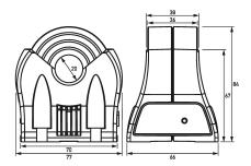
Maßzeichnung Differenzstrommonitore DCTR A 020/0,30-I
