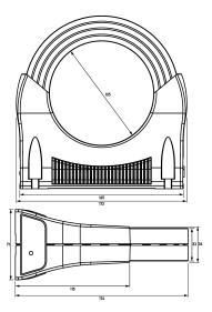
Maßzeichnung Differenzstrommonitore DCTR A 105/0,30-l
