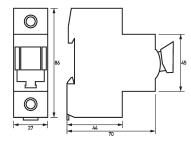
Maßzeichnung Sicherungslasttrennschalter Tytan II Do-63-1/S
