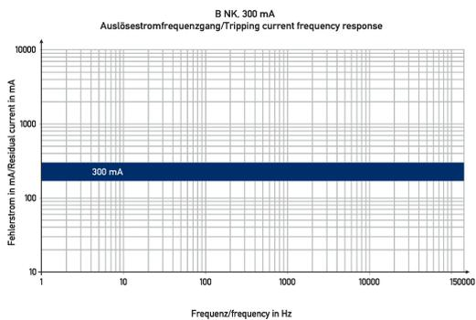
Diagramme Fehlerstromschutzschalter DFS 2 025-2/0,30-B NK
