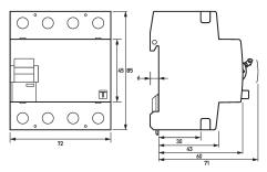
Maßzeichnung Fehlerstromschutzschalter DFS 4 040-4/0,30-B NK S
