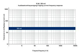
Diagramme Fehlerstromschutzschalter DFS 4 040-4/0,30-B NK S
