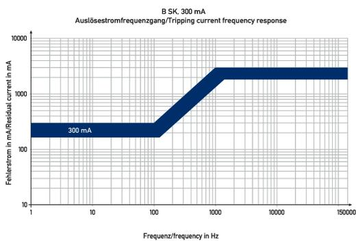
Diagramme Fehlerstromschutzschalter DFS 4 040-4/0,30-B SK S
