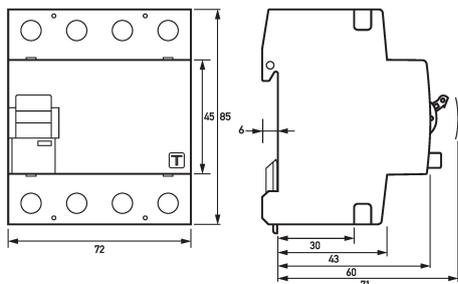
Maßzeichnung Fehlerstromschutzschalter DFS 4 040-4/0,30-B SK S
