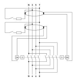
Schaltungsbeispiel Fehlerstromschutzschalter DFS 4 040-4/0,03-A KV Twin
