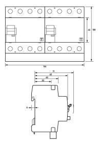
Maßzeichnung Fehlerstromschutzschalter DFS 4 040-4/0,03-A KV Twin
