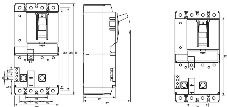
Maßzeichnung Leistungsschalter mit Fehlerstromschutz DFL 8 100-4/0,03-B NK
