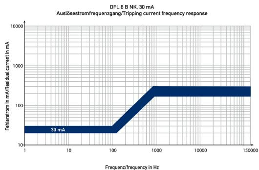
Diagramme Leistungsschalter mit Fehlerstromschutz DFL 8 100-4/0,03-B NK
