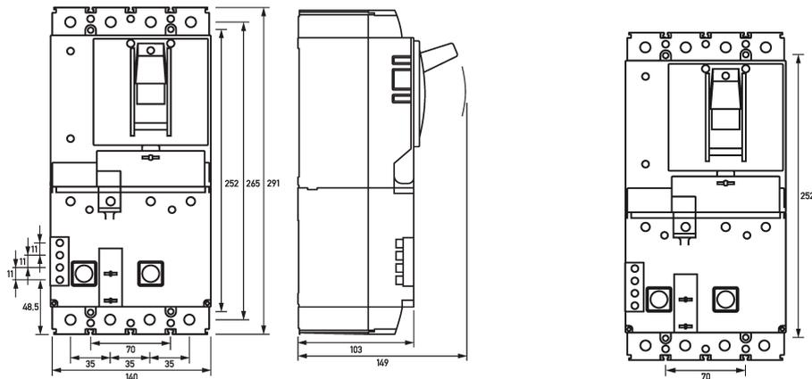
Maßzeichnung Leistungsschalter mit Fehlerstromschutz DFL 8 100-4/X-B NK
