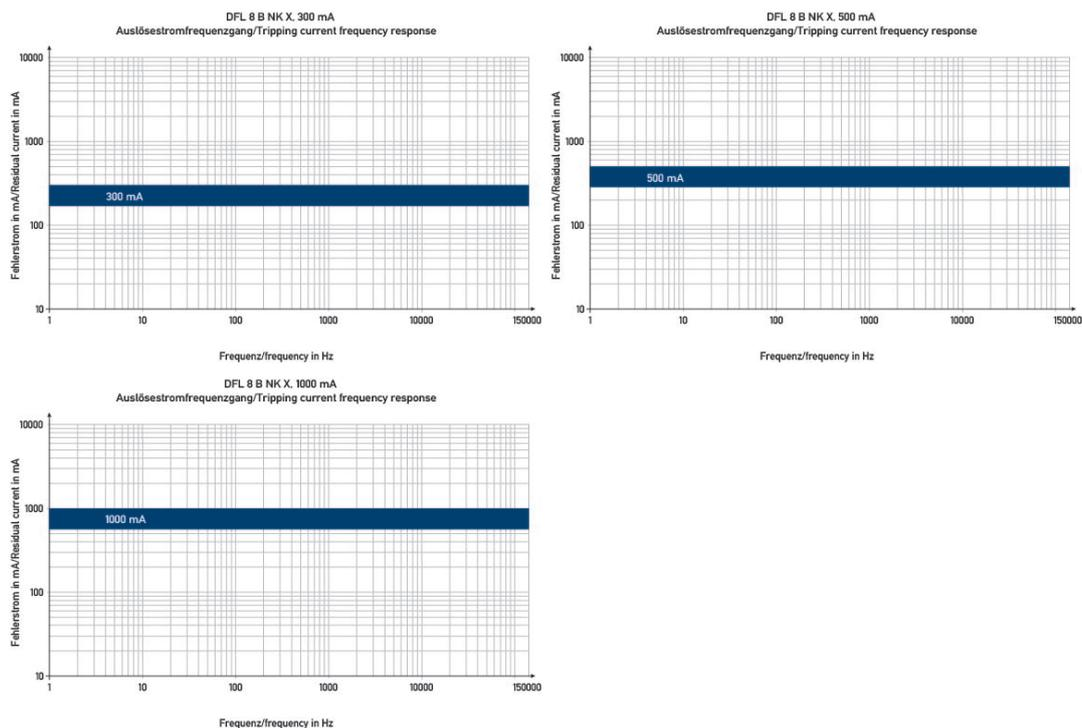
Diagramme Leistungsschalter mit Fehlerstromschutz DFL 8 100-4/X-B NK
