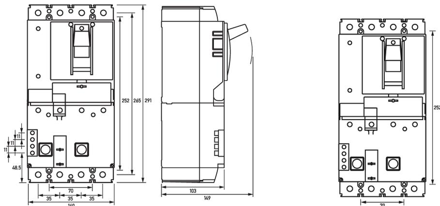
Maßzeichnung Leistungsschalter mit Fehlerstromschutz DFL 8 125-4/X-A
