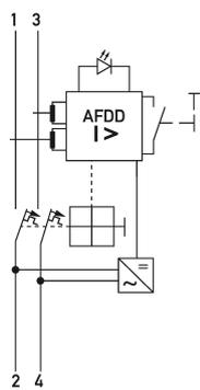
Schaltungsbeispiel Fehlerlichtbogen-Schutzeinrichtungen DAFDD 1 B16/0,03/2-A KV
