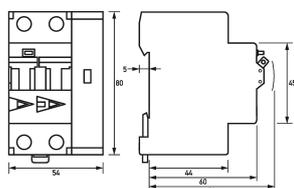
Maßzeichnung Fehlerlichtbogen-Schutzeinrichtungen DAFDD 1 B16/0,03/2-A KV
