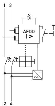
Schaltungsbeispiel Fehlerlichtbogen-Schutzeinrichtungen DAFDD 1 C10/0,03/2-A KV
