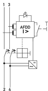
Schaltungsbeispiel Fehlerlichtbogen-Schutzeinrichtungen DAFDD 1 C16/0,03/2-A KV
