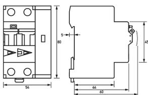
Maßzeichnung Fehlerlichtbogen-Schutzeinrichtungen DAFDD 1 C16/0,03/2-A KV
