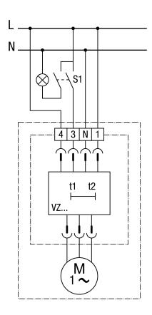
Ventilator läuft immer in Grundlast. Bei Raumbenutzung (S1 = Ein) schaltet der Ventilator nach ca. 50 Sekunden selbsttätig auf Volllast um.
