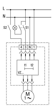
Bei Raumbenutzung (S1 = Ein) schaltet der Ventilator nach ca. 50 Sekunden selbsttätig auf Volllast um. Mit Schalter S2 kann der Grundlastbetrieb manuell ausgeschaltet werden.
