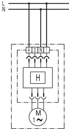
Ventilator läuft immer in Grundlast. Bei Luftfeuchtigkeit oberhalb der Einschaltfeuchte schaltet der Ventilator selbstständig auf Volllast um.
