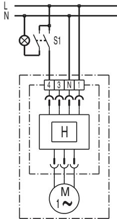
Der Ventilator wird mit Schalter S1 manuell auf Grundlast geschaltet. Bei Luftfeuchtigkeit oberhalb der Einschaltfeuchteschaltet der Ventilator selbsttätig auf Volllast um.
