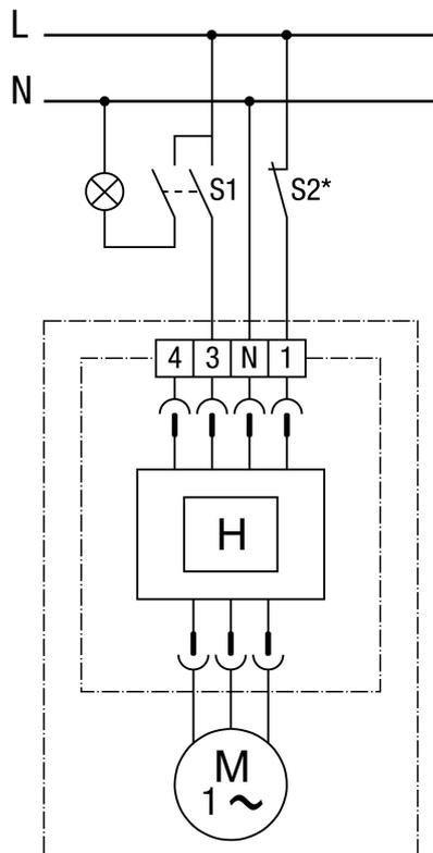
Der Ventilator wird mit Schalter S1 manuell ein- und ausgeschaltet. Der Ventilator läuft so lange nach, bis die Luftfeuchtigkeit im Raum unter die Ausschaltfeuchte gefallen ist.
