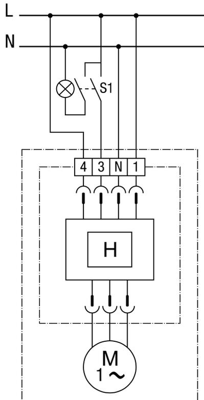
Ventilator läuft immer in Grundlast. Bei Luftfeuchtigkeit oberhalb der Einschaltfeuchte schaltet der Ventilator selbstständig auf Volllast um. Zusätzlich kann mit Schalter S1 manuell auf Volllast geschaltet werden. Bei Verwendung eines 1-poligen Schalters können Rückspannungen auftreten. Kombination mit einem X2-Kondensator notwendig!
