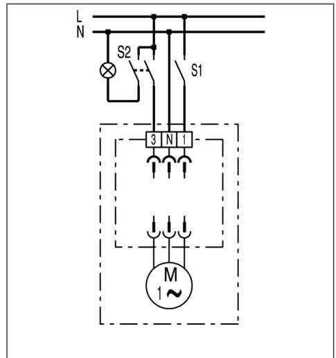
Das Gerät mit Grundlastfunktion kann je nach Bedarf mit Grundlast oder Volllast betrieben werden.
