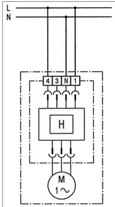
Gerät mit Feuchtesteuerung.
