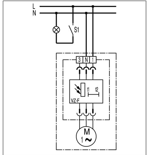
Der F-Ventilator ist für den Einbau in fensterlose, dunkle Räume vorgesehen. Über die Helligkeit der Raumbeleuchtung wird das Gerät drahtlos über eine Lichtsteuerung eingeschaltet. Das Gerät läuft nach ca. 50 Sekunden an.
