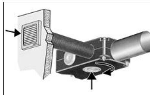
15. Remettre en place la soupape d'air entrant ou sortant et la fermeture de révision.
