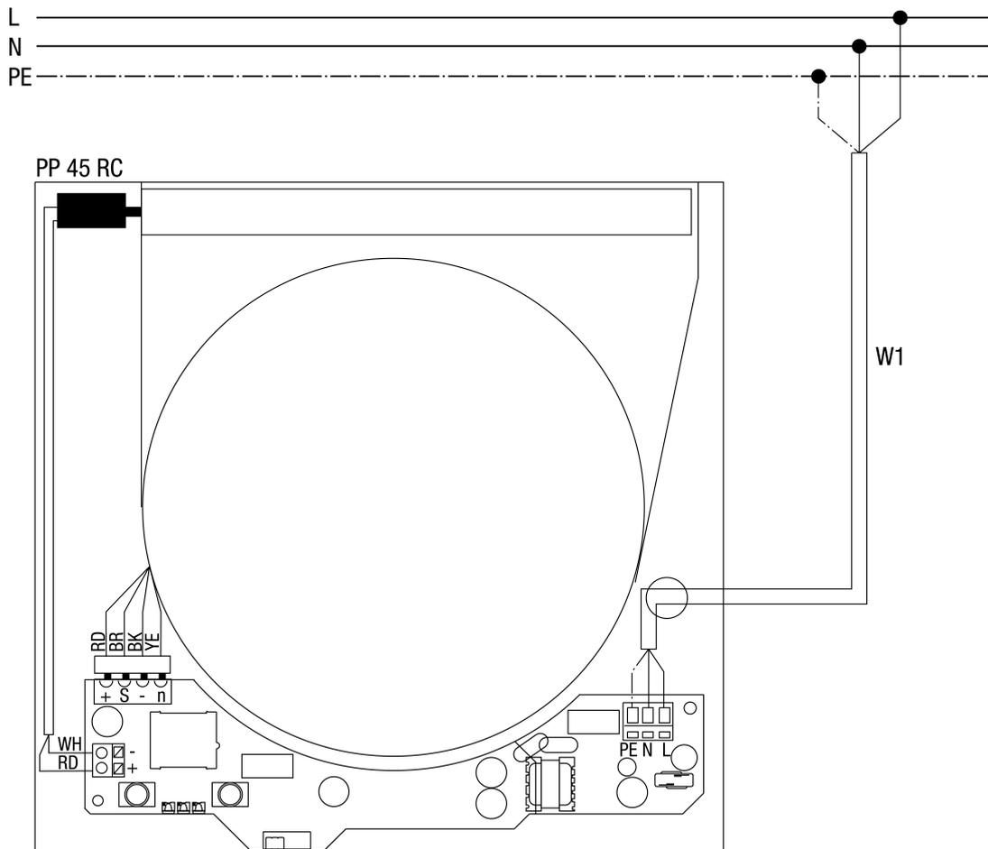
PP 45 RC - Lüftungsgerät PP 45 RC
