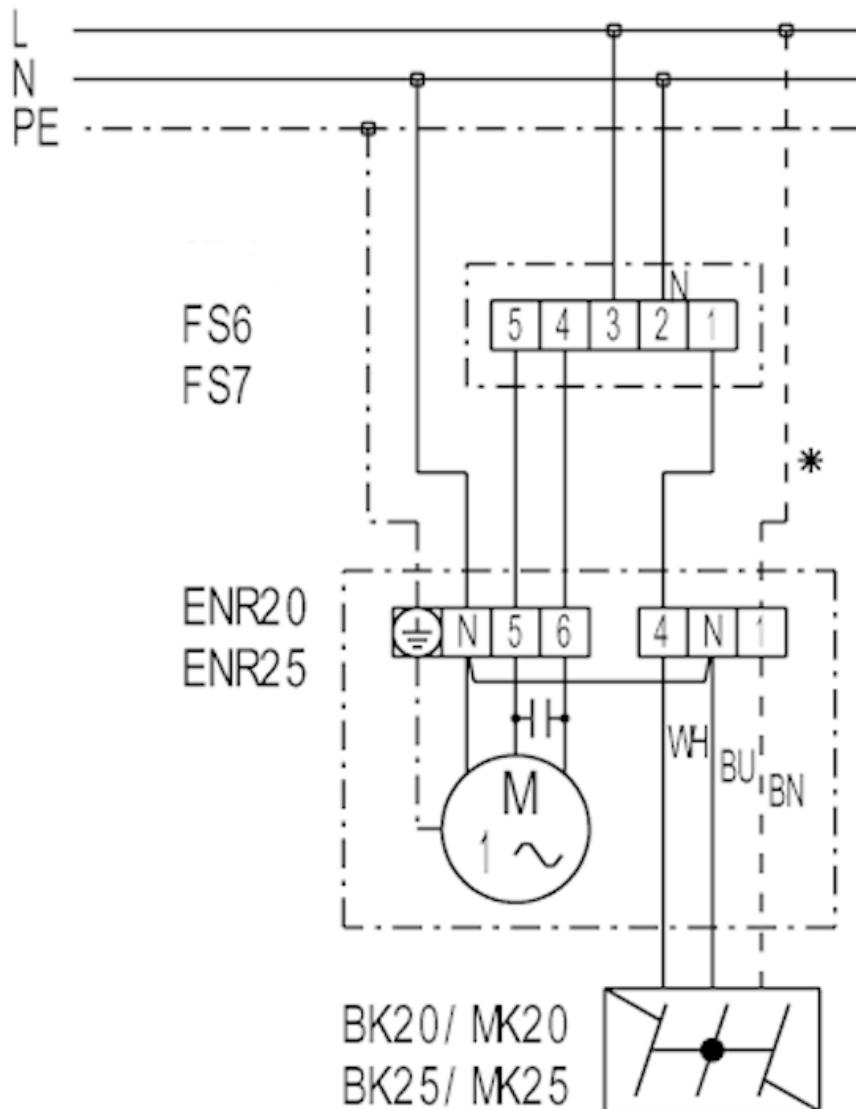
FS 6 - Stufenschalter (2 Drehzahlen, Ent-/Belüftung)
