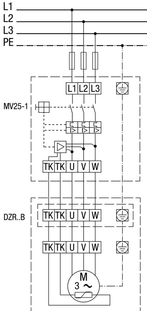
Mit Motoschutzschalter MV 25-1 und 5-Stufentransformator TR..
