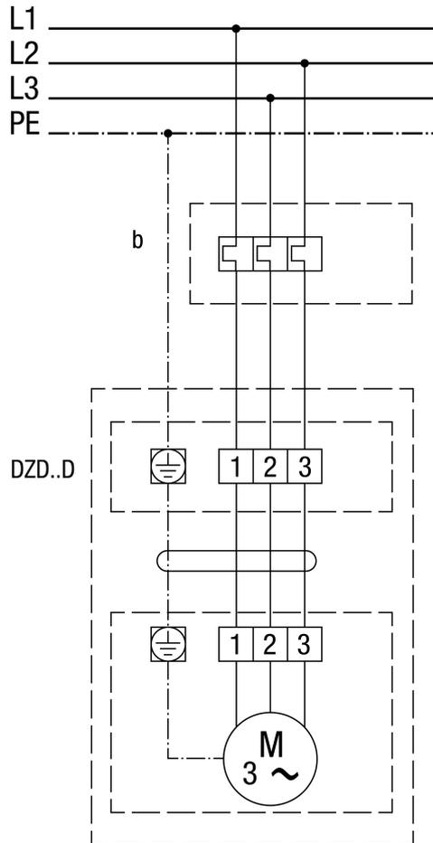
Für Rechtslauf am Ventilatoranschluss 2 Phasen tauschen
