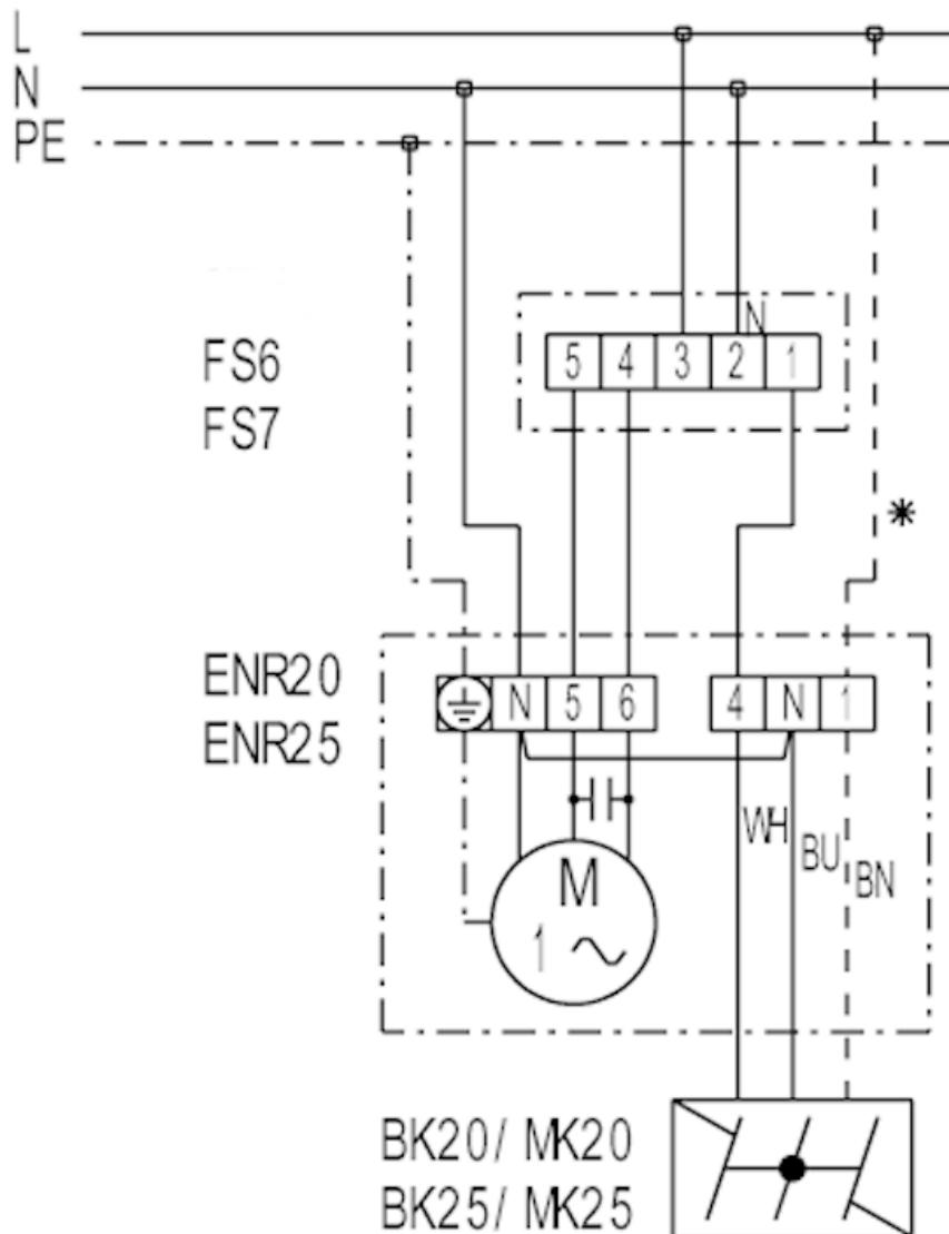
FS 6 - Stufenschalter (2 Drehzahlen, Ent-/Belüftung)
