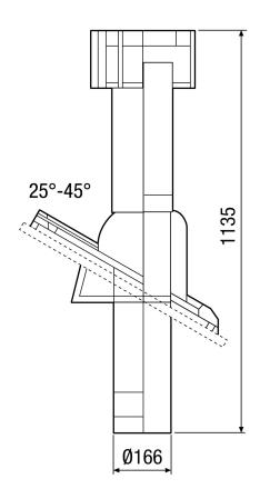
DF 160 S mit DP 160 SB Für Schrägdach
