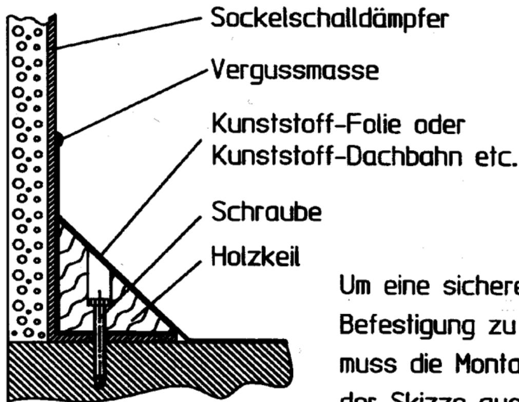
Um eine sichere und dauerhafte Befestigung zu gewährleisten, muss die Montage entsprechend der Skizze ausgeführt werden.
