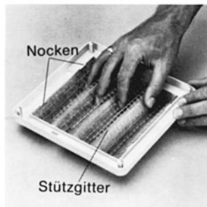
5. Stützgitter zuerst auf einer Seite unter die Nocken schieben. Dann den übrigen Teil in die Wellenform drücken. Gitterende unter die Nocken der anderen Seite.
