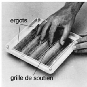
5. Enclencher la grille de soutien tout d'abord sous les ergots d'un côté du cadre. Ensuite presser la partie restante dans la forme ondulée et l'enclencher sous les ergots de l'autre côté du cadre.
