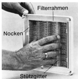
2. Stützgitter hinter den Nocken hervorziehen und zusammen mit der Filtermatte aus dem Filterrahmen nehmen.
