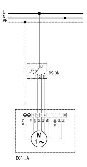
DS 3N - 3-Stufenschalter Klemmen 1-4 sind die Wicklungen des Motors. Klemmbelegung als Beispiel: Kleinste Drehzahl (Klemme 1) wird hier nicht verwendet.
